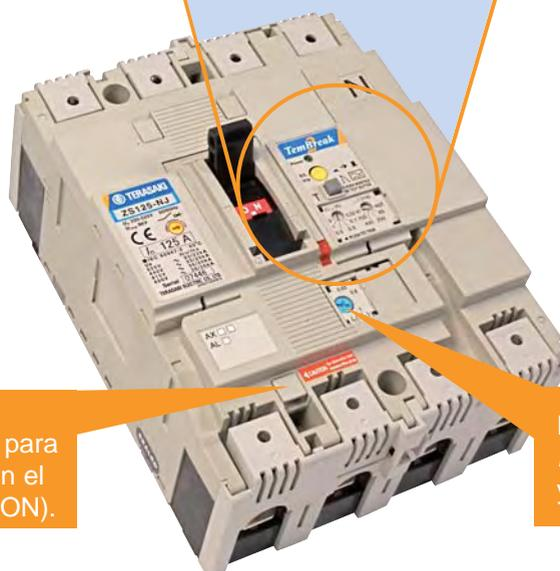
Dispositivo de comprobación dieléctrica. Extraer el obturador para permitir el ensayo dieléctrico con el interruptor combinado cerrado (ON).
